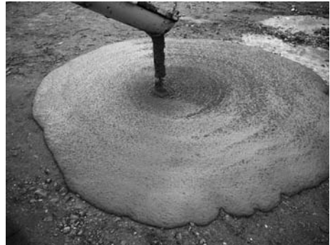
Kuva 1. Itsetiivistyvä betoni on nestemäistä, koossapysyvää betonia, jolla on kyky tiivistyä painovoimaisesti ilman perinteistä betonin tärytystä.
