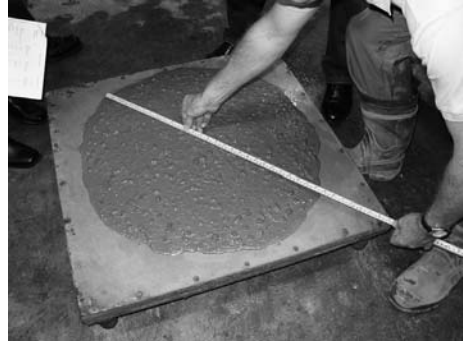
Kuva 3. Itsetiivistyvän betonin painumaleviämä on jopa yli 700 mm ja massa on kuitenkin erottumatonta ja homogeenista.
