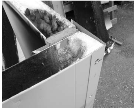
Kuva 6. Teräsohutlevypinnoitettu EPS-elementti SBI-kokeen jälkeen. EPS-eriste on kutistunut ja sulanut peltien välissä. Testatussa elementissä ei käytetty kipsilevyä suojaverhouksena.
