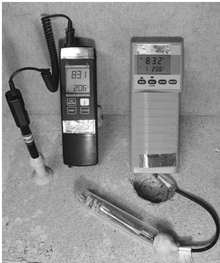
Kuva 2. Vasemmalla lukemienotto suhteellisen kosteuspitoisuuden mittapäistä, joka on asennettuna oikein valmisteltuun porareikämittausputkeen. Oikealla näytepalamittaus näyttölaitteen alla näkyvästä montusta otetuista betonimuruksista.
