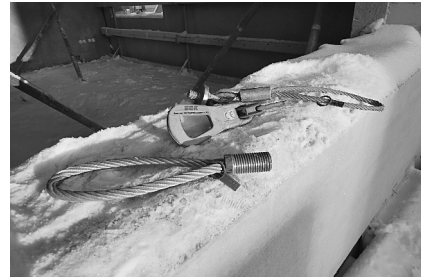
Kuva 4. Vajjerinostolenkki, nostolukko ja painelevyllinen nostolenkki. Merkintälevykkeessä kierretyyppi ja -koko, sallittu kuorma sekä valmistusvuosi.
