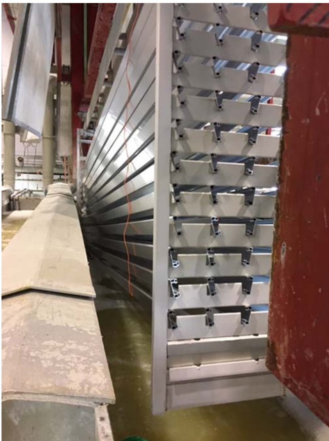
Kuva 6. Alumiiniprofiilien anodisointi. Profiilit upotetaan altaaseen ja sähkövirran ja rikkihappoliuoksen avulla sen pintaan saadaan suojaava oksidikerros. Kerros kasvaa alumiinin sisään.
